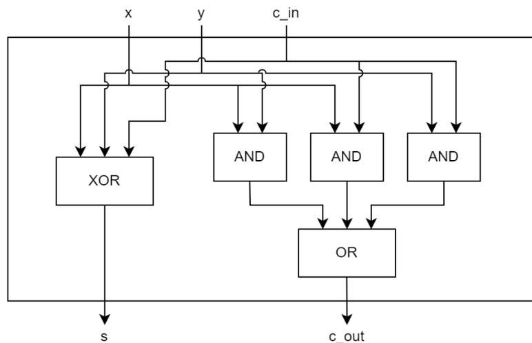
Vediamo ora il caso di un full adder a 3 bit ( [testbench](#), [descrizione](#), [sintesi](#) ).
