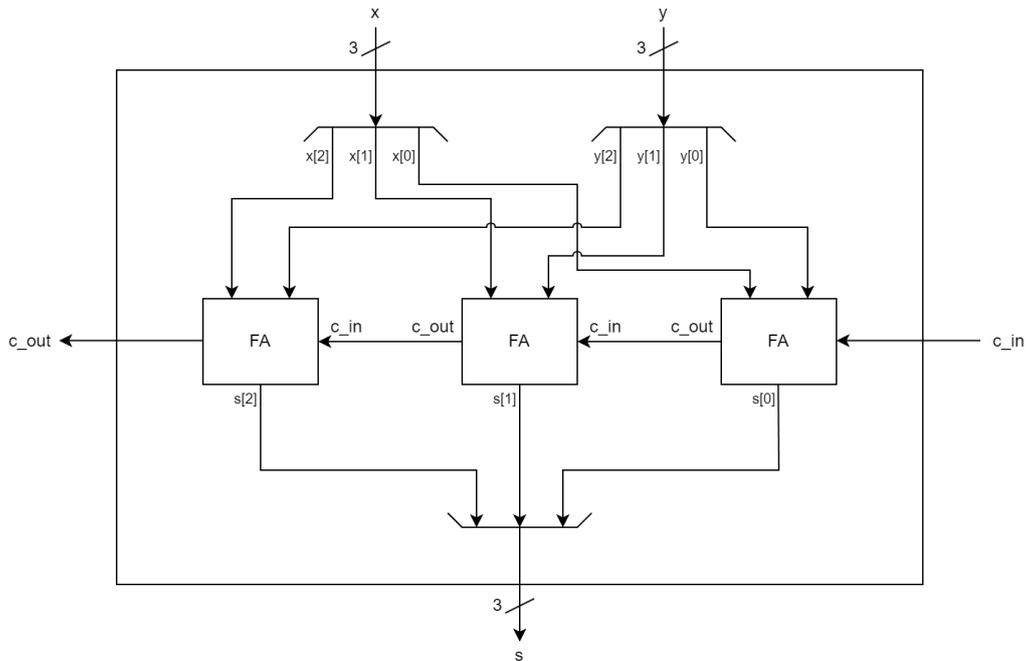
Da questo schema, si evince che sappiamo realizzare un full adder a 3 bit se sappiamo già realizzare un full adder a 1 bit. Questa relazione si conserva anche nel codice Verilog: nella sintesi di una rete combinatoria si possono utilizzare altre reti combinatorie di cui, a loro volta, si conosce la sintesi.
