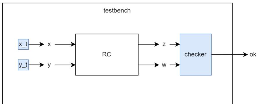
Il corrispettivo nel mondo software è un programma di test che prova i metodi e strutture dati di una libreria. Anche noto come *unit test*.
