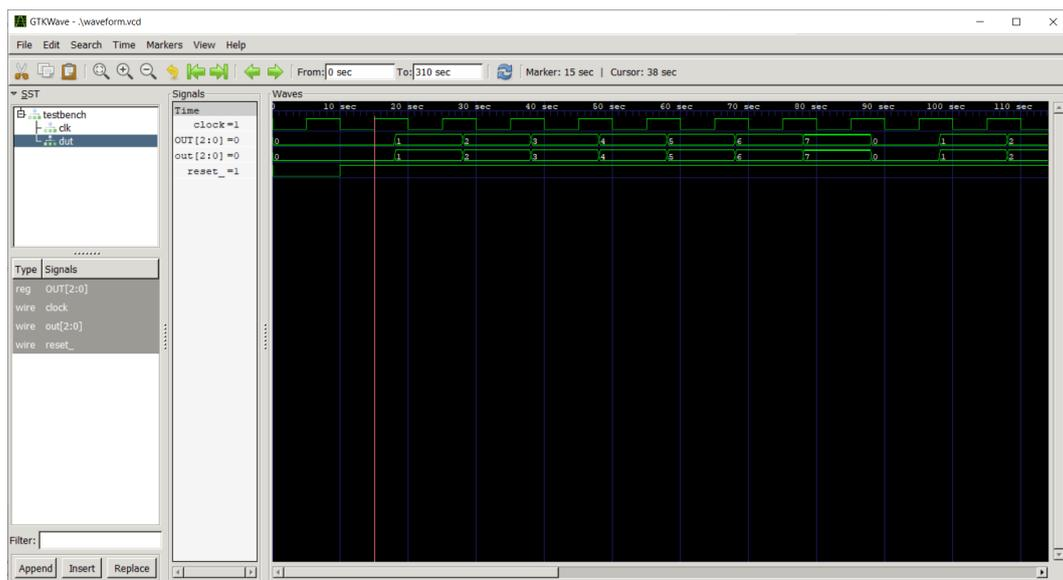
Osserviamo, in particolare, il registro OUT e il segnale del clock. Notiamo che a ogni fronte positivo del clock, OUT non cambia immediatamente, ma solo dopo 3 unità di tempo.
