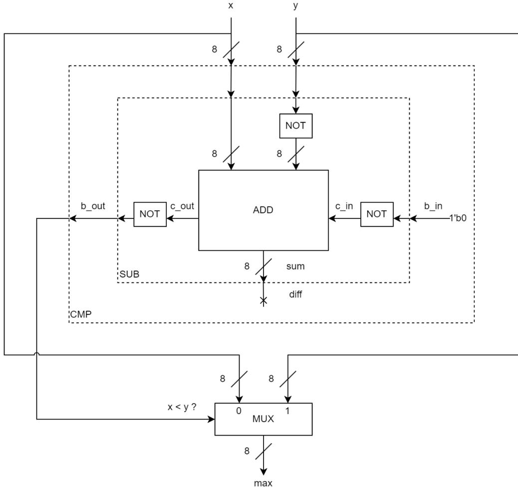
Abbiamo quindi una rete sintetizzabile: usiamo solo dei not, un multiplexer e un sommatore a 8 bit, quest'ultimo sintetizzabile perché parte della libreria `reti_standard.v`. Possiamo ora scrivere l'equivalente in Verilog, specificando per il sommatore  $N = 8$ . Questo parametro viene impostato all'istanziamento del sommatore, e deve essere una costante: determina infatti la quantità di hardware utilizzata, e non si può cambiare l'hardware a runtime.
