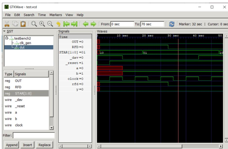
Il programma mostra sulla sinistra le varie componenti nella simulazione e, se li selezioniamo, i fili e registri che li compongono. Ci interesserà in particolare `dut` (*device under test*), che sarà proprio il componente da noi realizzato. Selezionando poi i vari `wire` e `reg` che compaiono sotto, e cliccando "Append", compariranno nella schermata a destra, dove possiamo vedere l'evoluzione nel tempo.
