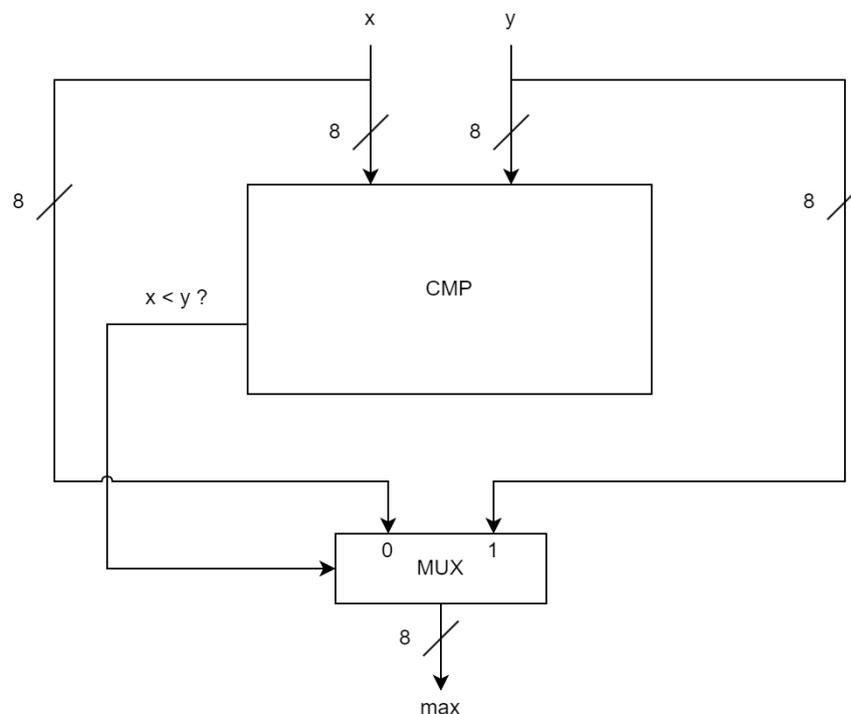
$x < y$  equivale a  $x - y < 0$ . Dato che  $x$  e  $y$  sono numeri naturali, questo equivale a chiedersi se la loro sottrazione genera un prestito uscente. Posso quindi realizzare questo comparatore usando un sottrattore.
