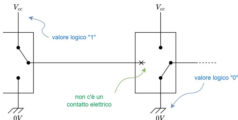
Cosa succede invece se colleghiamo le uscite di due porte logiche, in particolare se una produce 1 e l'altra 0? Si chiude un circuito che collega  $V_{cc}$  a *terra*. Data la differenza di potenziale, scorre corrente. Data la bassissima resistenza di un semplice filo, scorre tanta corrente. Data la relazione tra la potenza dissipata in calore e la corrente che attraversa il circuito,  $P = R \cdot i^2$ , viene dissipato tanto calore. Il circuito [prende fuoco](#) 🔥.
